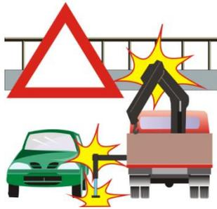
TWI (Truck Warning Interface) überwacht die Kranarmstellung und gibt Alarm sobald sich der Kran nicht in Transportposition befindet.
