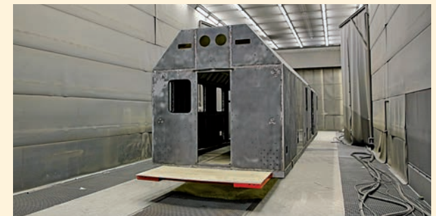
Sandstrahlkabine 30 m x 8 m Sandblasting booth 30 m x 8 m
